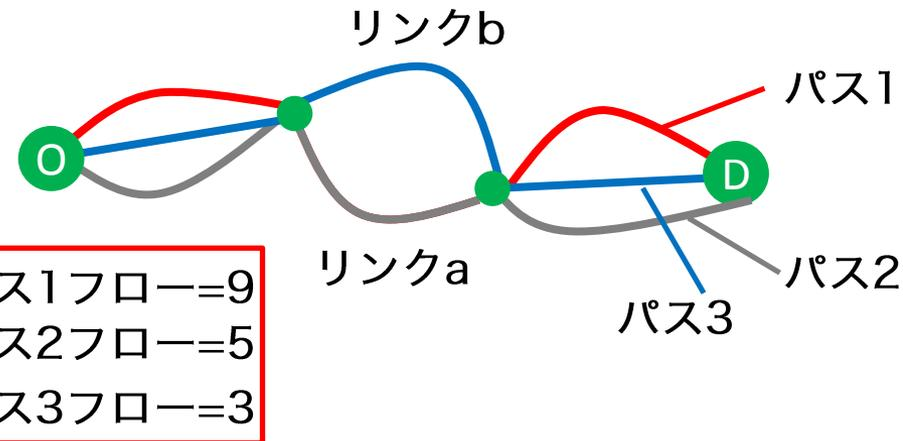
$$\begin{aligned} \text{OD間フロー数} &= \text{パス1フロー数} + \text{パス2フロー数} + \text{パス3フロー数} \\ &= 9 + 5 + 3 = 17 \end{aligned}$$
